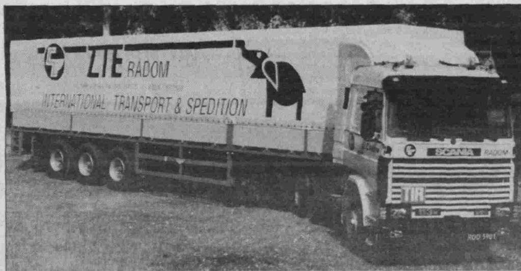
Zestaw do przewozu ładunków uniwersalnych. Ciągnik marki „scania”. Naczepa marki „broshuis”. Ładowność dopuszczalna 39 ton. Maksymalna długość naczepy (można rozsuwać) – 21,5 m.
