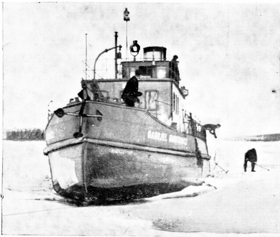
Podczas roztopów wiosennych na zamrożniętej Wiśle tworzą się wielkie zatopy lodowe tamujące normalny bieg rzeki, powodując wielkie wylewy. Aby zapobiec tej klęsce na dolnym biegu Wisły, od ujścia aż do Tczewa, pracuje 5 statków, tak zwanych ładołamaczy lodów. Usunięcie bowiem zwartej pokrywy lodowej zmniejsza możliwość grożącego niebezpieczeństwa. Zdjęcie przedstawia ładołamacza pod nazwą „Gabriel Narutowicz” podczas pracy.
