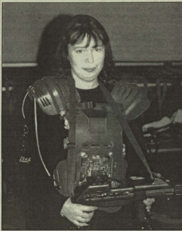
Wyposażenie żołnierza to specjalna kamizelka z czujnikiem i karabin strzelający laserowym światłem
