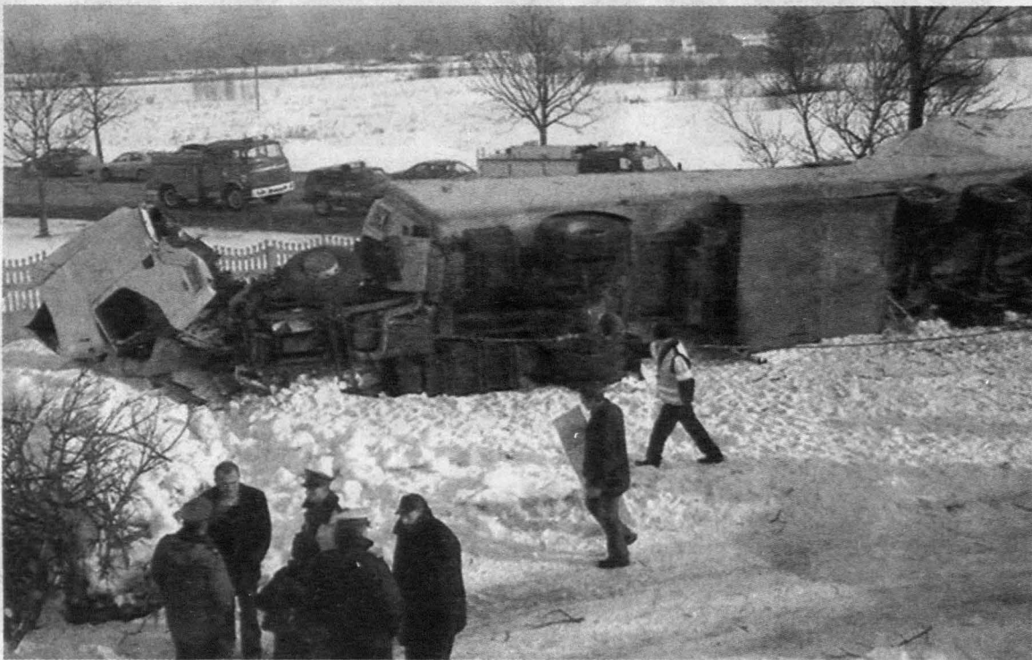
Kabina tira została rozbita po zderzeniu z drzewem, naczepę zniszczyły przemieszczające się palety z materiałami budowlanymi
