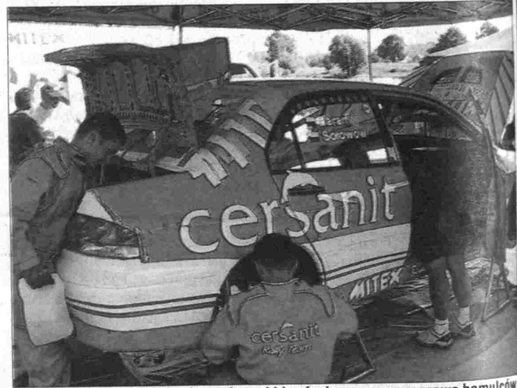
20 minut. Tyle trwają wymiana skrzyń biegów i opon oraz naprawa hamulców, kompleksowe sprawdzenie silnika i tankowanie paliwa w Mitsubishi Lancer Evo VII kieleckiej załogi Cersanitu Rally Team
