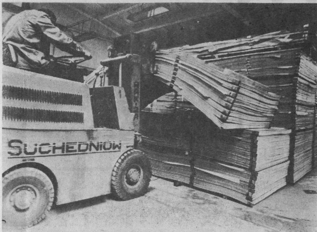
Transport wewnątrz zakładu rozwiązany jest przy użyciu wózków widłowych.
