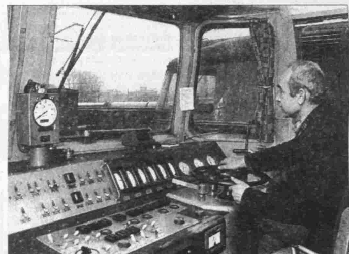
Wnętrze kabiny elektrowozu. Z tego miejsca maszynista decyduje o całym składzie pociągu
