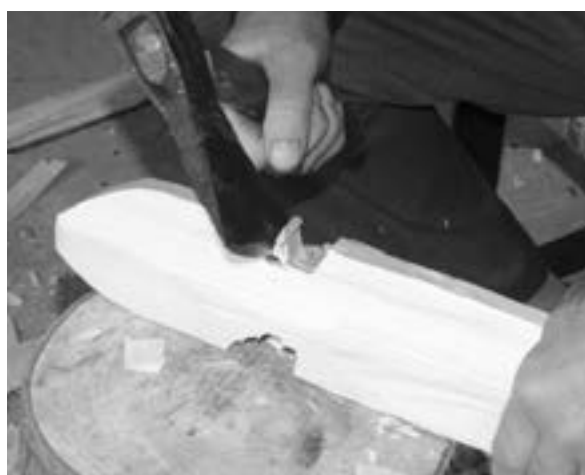
Fot. 4. Wstępna obróbka siekierką
