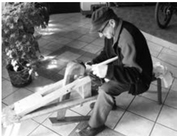
Fot. 8. Obróbka olśnikiem na kobylicy
