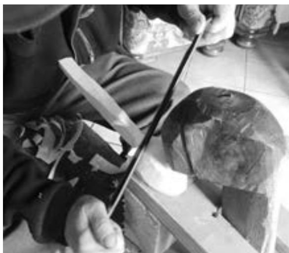
Fot. 9. Obróbka olśnikiem
