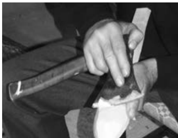
Fot. 5. Formowanie pyska siekierką
